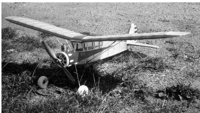
Kabinový hornoplošník KOLIBŘÍK od Gustava Buška postavil jako repliku Bronislav Sokolíček z Olomouce. Poprvé s ním létal před 62 lety. Nyní je osazen detonační jedničkou vlastní konstrukce a výroby autora.
