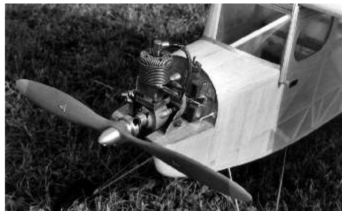
Detail instalace benzínového motoru ALKO 14 cm 3 v modelu HANGAR No. 13.
